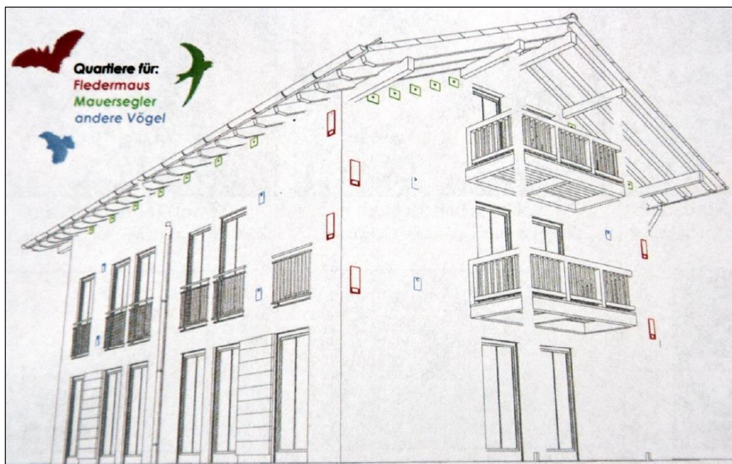
Abb. 6 mögliche Positionen für künstliche Quartiere für Fledermäuse an Gebäuden (Quelle: LBV München)
