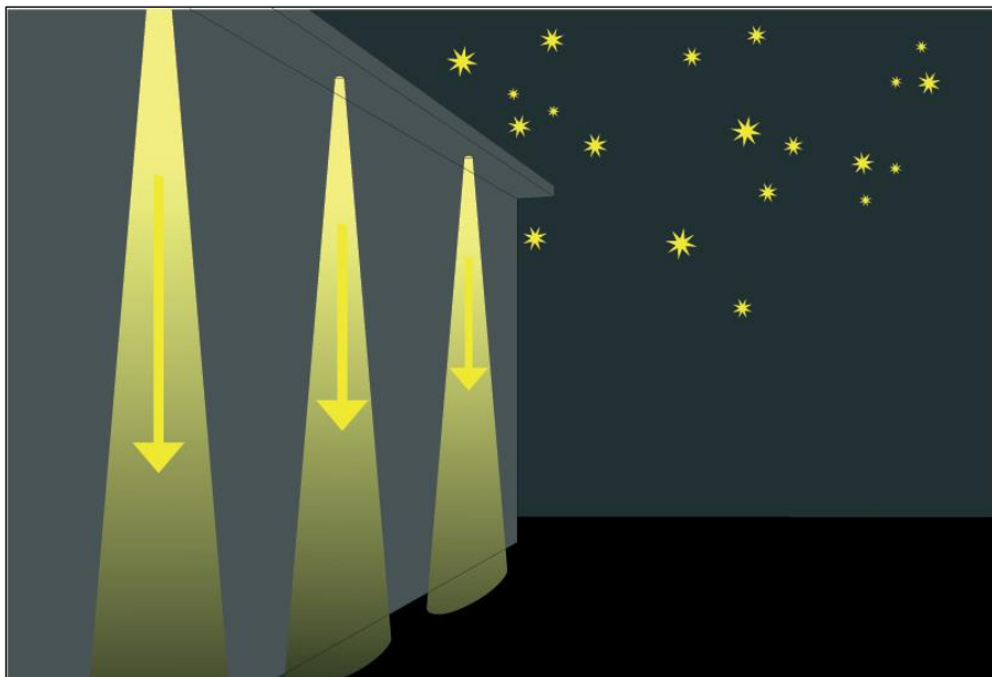
Abb. 4 Gebündelte Beleuchtung von oben auf die effektiv zu erhellende Fläche
